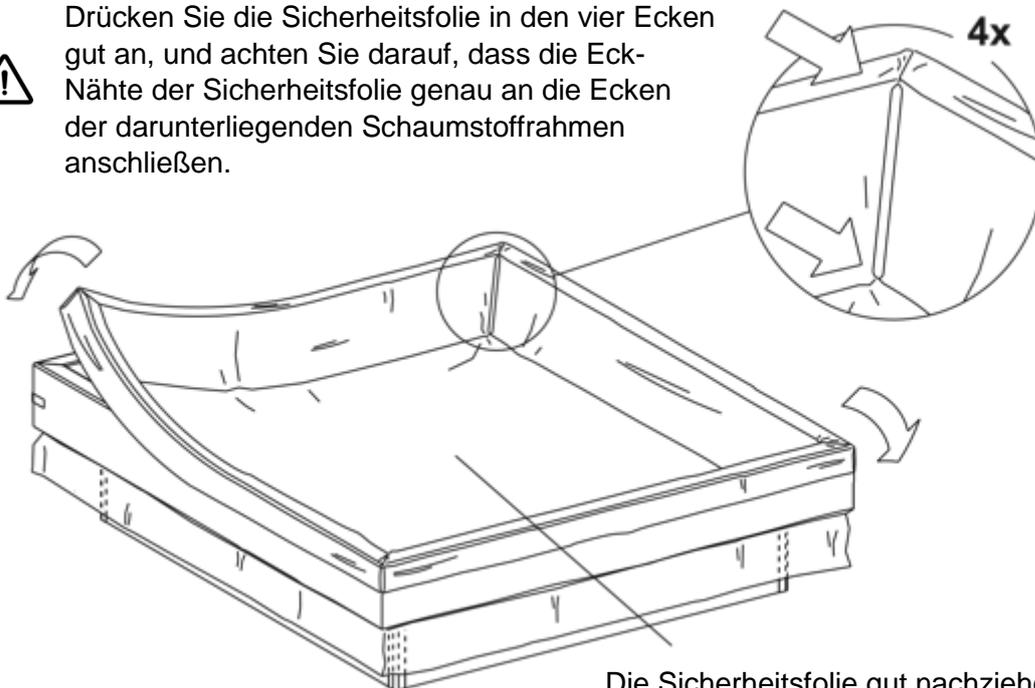
**!** Die Sicherheitsfolie gut nachziehen, damit keine Falten auf dem Boden entstehen.
