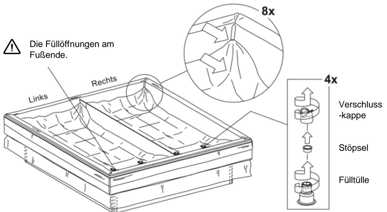
Bei einer Duo-Ausführung gibt es eine linke und eine rechte Wassermatratze, achten Sie auf die Angabe „left“ und „right“ auf dem Label. Die Wassermatratzen schließen genau an die Form des Schaumstoffrahmens an.
