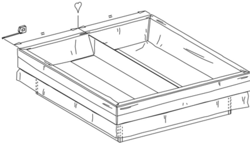
**!** Die Sicherheitsfolie noch nicht mit dem Klettband festmachen, erst lose ohne Spannung am Schaumstoffrahmen anbringen. Andernfalls wird der Schaumstoffrahmen beim Füllen krummgezogen.
