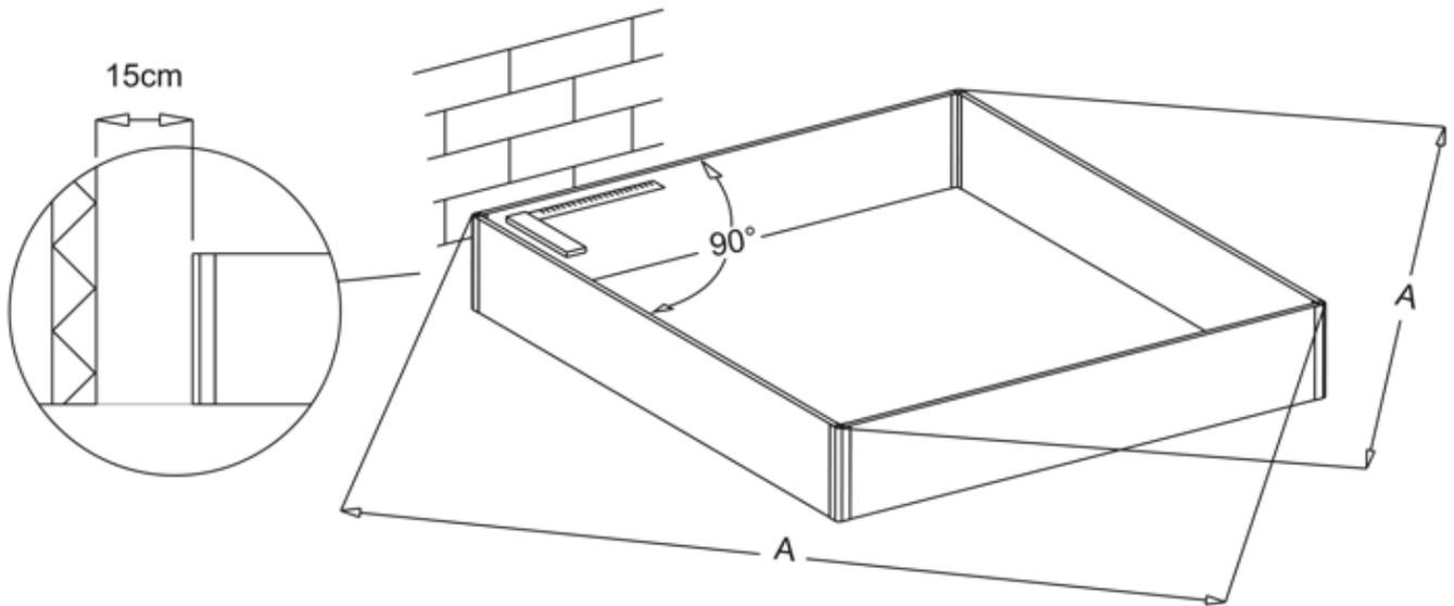
**!** Platzieren Sie die Leisten sorgfältig im rechten Winkel, überprüfen Sie dies, indem Sie dafür sorgen, dass die beiden Übereck-Maße A gleich sind.
