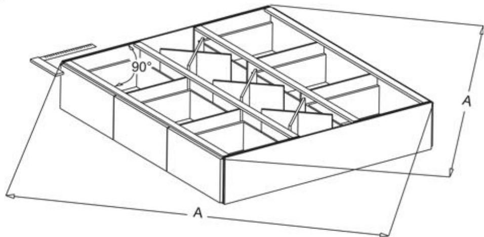
**⚠** Platzieren Sie das Podest sorgfältig im rechten Winkel, überprüfen Sie dies, indem Sie darauf achten, dass die beiden Übereckmaße A gleich sind.
