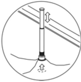
Anschließend den Conditioner dazugeben. Danach den Stöpsel und Schraubverschluss wieder anbringen und die Fülltüle wieder in die Wassermatratze drücken.
