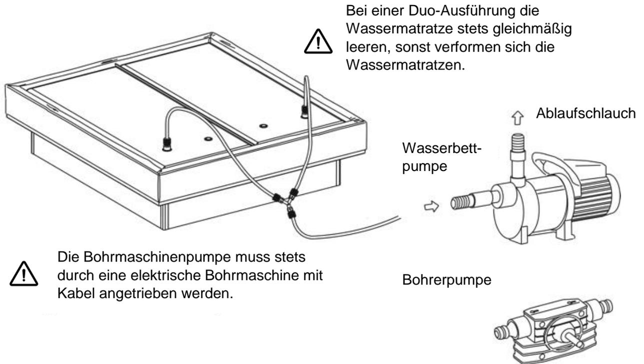
Bei einer Duo-Ausführung die Wassermatratze stets gleichmäßig leeren, sonst verformen sich die Wassermatratzen.
