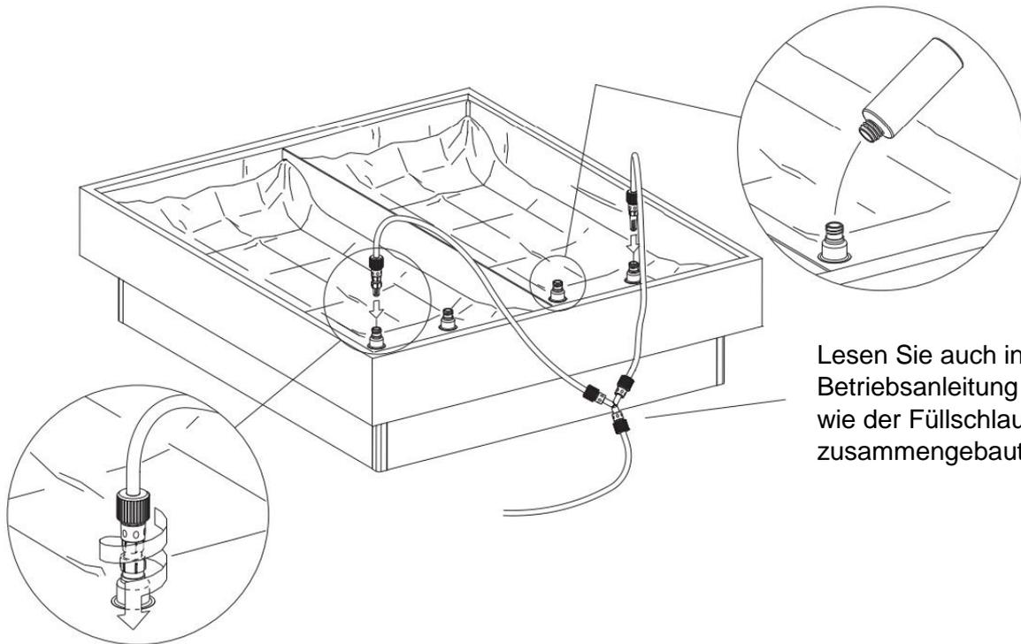
Lesen Sie auch in der Betriebsanleitung nach, wie der Füllschlauch zusammengebaut wird.
