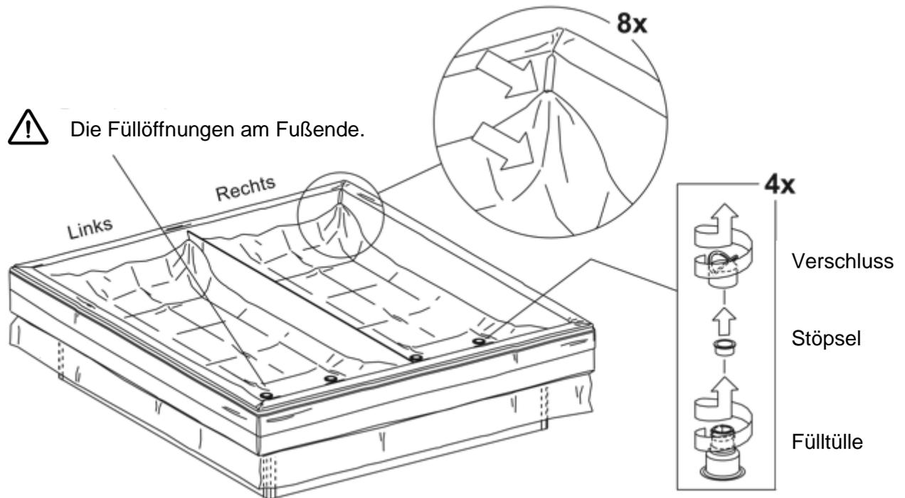
Bei einer Duo-Ausführung gibt es eine linke und eine rechte Wassermatratze. Beachten Sie die Angabe "left" und "right" auf dem Label. Die Wassermatratzen sind genau auf die Form des Schaumstoffrahmens abgestimmt.
